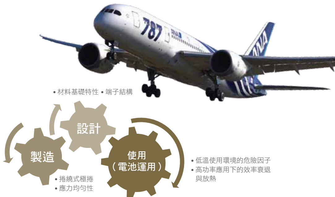
《圖一》UL 針對波音 787 鋰電池失效事故之因的調查快速示意
